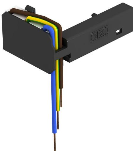
Módulo de protección contra sobretensiones de 2 polos, 16 A/250 V~, con indicación acústica de avería, sin desconexión de red, apropiado para la conexión en una toma de corriente múltiple Modul 45connect con el soporte suministrado. Para el montaje en cubetas universales UT3/45 y UT4/45. El módulo de protección contra sobretensiones se corresponde con EN 61643-11, tipo 3, clase III, requisito D.
