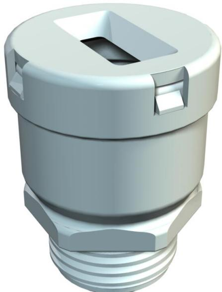
Prensaestopas para cables planos tipo racor estrangulador, con rosca de conexión PG según DIN 40430, grado de protección IP31, con anillo de sellado tipo 107/F premontado.
