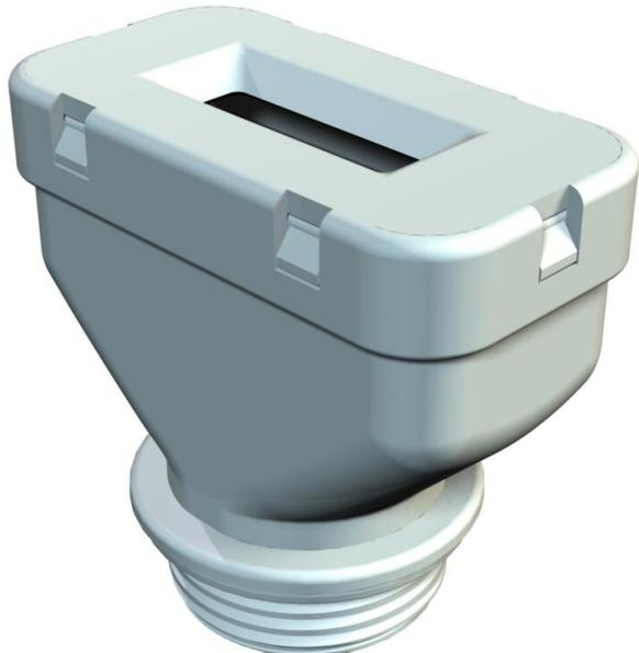
Prensaestopas para cables planos tipo racor estrangulador, con rosca de conexión PG según DIN 40430, grado de protección IP31, con anillo de sellado tipo 107/F premontado.
