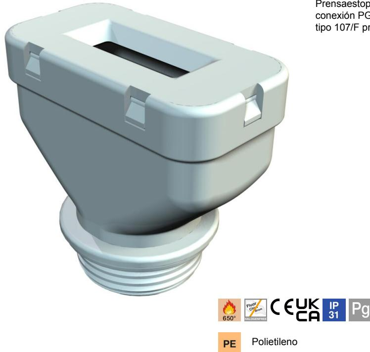
Prensaestopas para cables planos tipo racor estrangulador, con rosca de conexión PG según DIN 40430, grado de protección IP31, con anillo de sellado tipo 107/F premontado.
