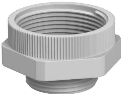
Extensión con rosca métrica interior y exterior para el montaje de prensaestopas de plástico en cajas. Clase de protección IP54 sin junta de conexión adicional. Clase de protección hasta IP68 posible con junta de conexión adicional, por ejemplo, junta tórica o junta plana de estanqueidad.
