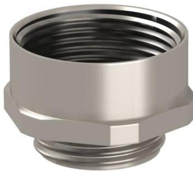
Extensión de latón con rosca métrica interior y exterior para el montaje de prensaestopas metálicos o de plástico en cajas. Clase de protección IP54 sin junta de conexión adicional. Clase de protección hasta IP68 posible con junta de conexión adicional, por ejemplo, junta tórica o junta plana de estanqueidad.
