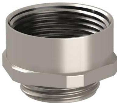
Extensión de latón con rosca métrica interior y exterior para el montaje de prensaestopas metálicos o de plástico en cajas. Clase de protección IP54 sin junta de conexión adicional. Clase de protección hasta IP68 posible con junta de conexión adicional, por ejemplo, junta tórica o junta plana de estanqueidad.
