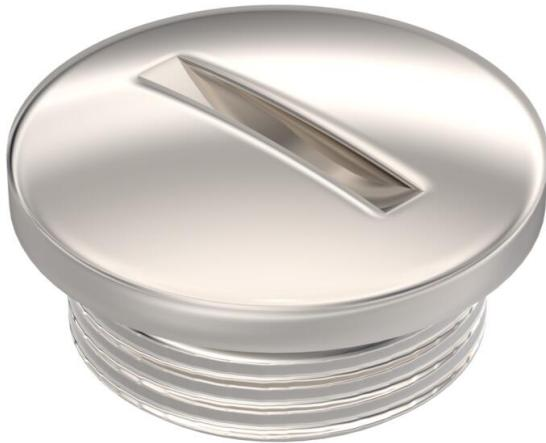
Tomillo de cierre metálico con junta de estanqueidad integrada. Para el cierre de orificios roscados no utilizados, p. ej., en carcasa o cajas de derivación. Con rosca métrica según DIN EN 60423 o ISO 68. Grado de protección IP 68 (5 bar/1 h).
