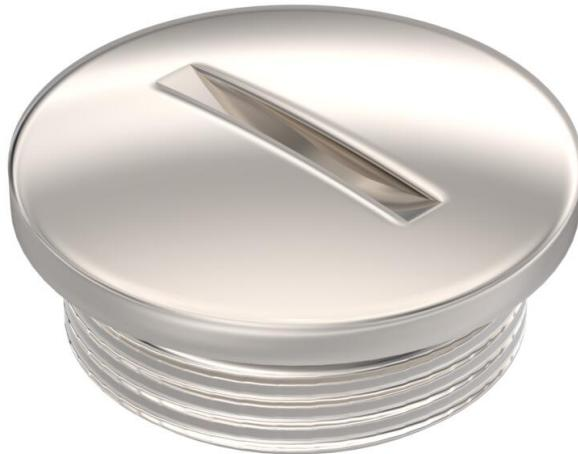
Tomillo de cierre metálico con junta de estanqueidad integrada. Para el cierre de orificios roscados no utilizados, p. ej., en carcasa o cajas de derivación. Con rosca métrica según DIN EN 60423 o ISO 68. Grado de protección IP 68 (5 bar/1 h).
