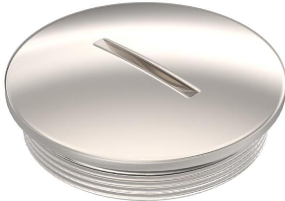
Tomillo de cierre metálico con junta de estanqueidad integrada. Para el cierre de orificios roscados no utilizados, p. ej., en carcasa o cajas de derivación. Con rosca métrica según DIN EN 60423 o ISO 68. Grado de protección IP 68 (5 bar/1 h).
