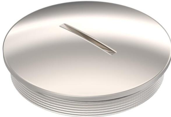
Tomillo de cierre metálico con junta de estanqueidad integrada. Para el cierre de orificios roscados no utilizados, p. ej., en carcasa o cajas de derivación. Con rosca métrica según DIN EN 60423 o ISO 68. Grado de protección IP 68 (5 bar/1 h).
