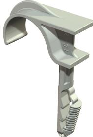
Las tacos-grapa sirven para tender conductores y tubos en paredes y techos y para tender tubos flexibles sobre hormigón y en pavimentos. Los tacos-grapa simples sustituyen a los clips de clavos en hormigón y en hormigón celular. La ventaja de los tacos-grapa estriba en que solamente se deben insertar en el orificio taladrado. No se requiere utilizar tacos ni tornillos.
