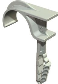
Las tacos-grapa sirven para tender conductores y tubos en paredes y techos y para tender tubos flexibles sobre hormigón y en pavimentos. Los tacos-grapa simples sustituyen a los clips de clavos en hormigón y en hormigón celular. La ventaja de los tacos-grapa estriba en que solamente se deben insertar en el orificio taladrado. No se requiere utilizar tacos ni tornillos.
