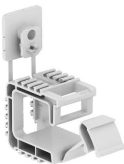
Soporte colector con elemento de fijación moldeado, para el montaje de hasta 10 cables NYM 3 x 1,5 mm<sup>2</sup> en la pared o en el techo. Fijación con taca o taca enchufable. También apto para la fijación con herramientas de ajuste a gas y a batería de Bosch, Fischer y Spit (diámetro interior de la punta Ø 7 mm). Orificio de fijación de Ø 6 mm. Distancia de montaje recomendada a plena ocupación 250-400 cm, en función de las especificaciones/normas nacionales aplicables.
