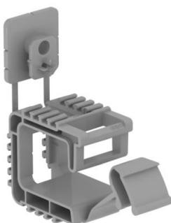
Soporte colectivo con elemento de fijación moldeado, para el montaje de hasta 10 cables NYM de 3 x 1,5 mm<sup>2</sup> en pared o techo. Fijación con taco de impacto o taco de expansión. Agujero de fijación de Ø 6 mm. Distancia de fijación recomendada con ocupación total de 250-400 cm depende de las normas y disposiciones nacionales vigentes en cada caso. Antiinflamable según DIN VDE 0471/DIN IEC 695, parte 2-1, temperatura de prueba 960 °C.
