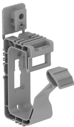
Soporte colector con elemento de fijación moldeado, para el montaje de hasta 20 cables NYM 3 x 1,5 mm<sup>2</sup> en la pared o en el techo. Fijación con taca de impacto o taca de expansión. Agujero de fijación de Ø 6 mm. Distancia de fijación recomendada con ocupación total de 250-400 cm depende de las normas y disposiciones nacionales vigentes en cada caso. Antiinflamable según DIN VDE 0471/DIN IEC 695, parte 2-1, temperatura de prueba 960 °C.
