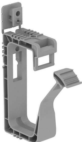
Soporte colector con elemento de fijación moldeado, para el montaje de hasta 40 cables NYM 3 x 1,5 mm<sup>2</sup> en la pared o en el techo. Fijación con taca de impacto o taca de expansión. Agujero de fijación de Ø 6 mm. Distancia de fijación recomendada con ocupación total de 250-400 cm depende de las normas y disposiciones nacionales vigentes en cada caso. Antiinflamable según DIN VDE 0471/DIN IEC 695, parte 2-1, temperatura de prueba 960 °C.
