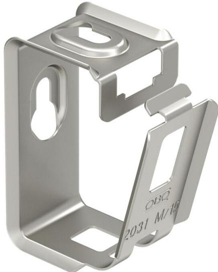
Abrazadera para haces de cables de metal para una elevada estabilidad mecánica incluso en caso de incendio. Apto para el montaje seguro sobre cubiertas de protección contra incendios. También está homologado como variante específica de cable para el mantenimiento de función eléctrica según DIN 4102, parte 12. Para montaje en pared y techo. El cierre se puede abrir sin herramientas.
