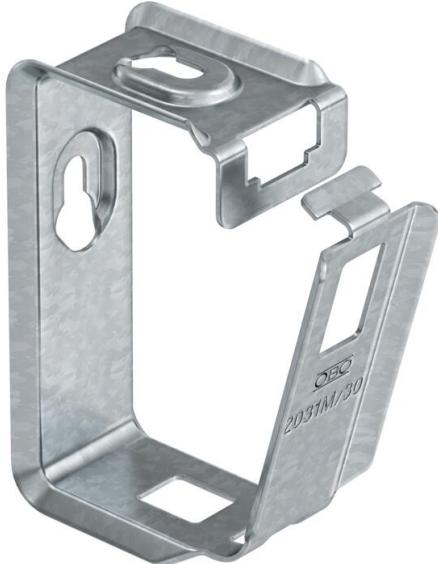
Abrazadera para haces de cables de metal para una elevada estabilidad mecánica incluso en caso de incendio. Apto para el montaje seguro sobre cubiertas de protección contra incendios. También está homologado como variante específica de cable para el mantenimiento de función eléctrica según DIN 4102, parte 12. Para montaje en pared y techo. El cierre se puede abrir sin herramientas.
