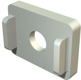
Para aumentar la altura de apriete de las abrazaderas de cables de 9 a 13 mm con conductores gruesos, poliestireno resistente a los impactos.
