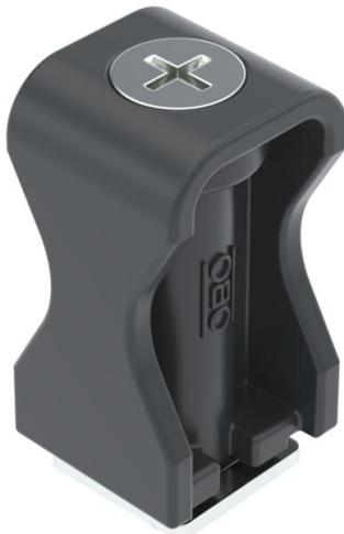
Versión para cargas pesadas, también adecuado para carriles con ancho de ranura de 16 ± 17 mm; cuerpo de abrazadera de poliamida, gris claro RAL 7035; piezas metálicas de acero, galvanizado en caliente.
