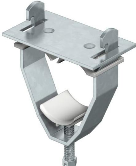
Cuerpo de abrazadera, tornillo y sufridera de acero galvanizado por inmersión, mediacaña y contra-mediacaña de polipropileno, libre de halógenos, gris claro RAL 7035.
