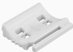
Independiente del tipo de carril, se puede aplicar de manera universal introduciéndola en un lateral de la abrazadera sobre perfil. Mediante un perfil inteligente de la parte trasera, se puede combinar con la bandeja doble. Instalación posterior sin tener que desmontar la abrazadera sobre perfil.
