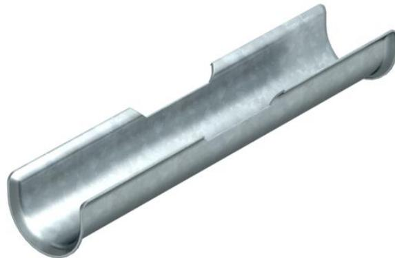
Para aumentar la superficie de apoyo de cables con mantenimiento de función integrado, se instala adicionalmente una mediacaña alargada (L = 200 mm) para la abrazadera sobre perfil.
