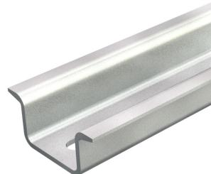
Carril DIN 35 x 15 mm según EN 60715 (antes DIN EN 50022), pero con un espesor de material de 1,5 mm.
