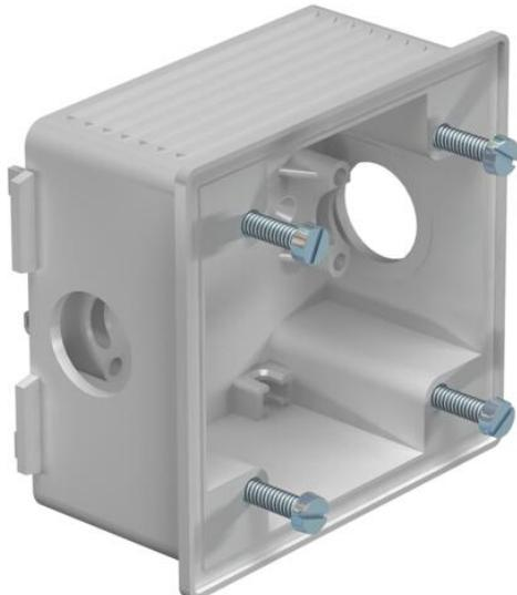
Caja portamecanismos para el montaje de tomas de corriente CEE en canales WDK a partir de ancho de canal de 150 mm. La caja portamecanismos también se puede utilizar como caja empotrada en aparatos CEE. Modelo recto, 16 y 32 A, con separación de orificios 60 x 60 mm
