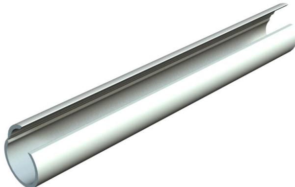
Tubo de registro Quick-Pipe de plástico para la instalación sobre superficie de cables y líneas, en zonas interiores y exteriores, protegidas. Montaje en pared y techo con abrazadera Quick, abrazadera Star-Quick y abrazadera Multi-Quick. Cierre y apertura sin herramientas girando la abrazadera. Utilizable en el margen de temperatura de -25 °C a +60 °C.
