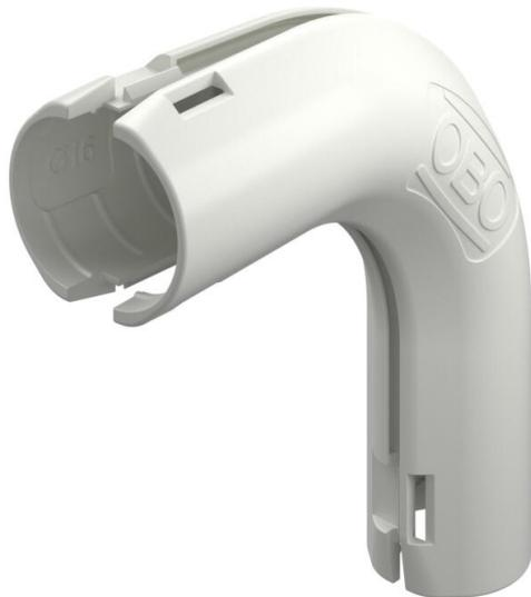
Pieza preformada para tubos de plástico para la instalación eléctrica para crear una curva de 90°. Adecuado para Quick-Pipe® o tubo corrugado. Cierre y apertura sin herramientas. Utilizable en el margen de temperatura de -25 °C a +60 °C.
