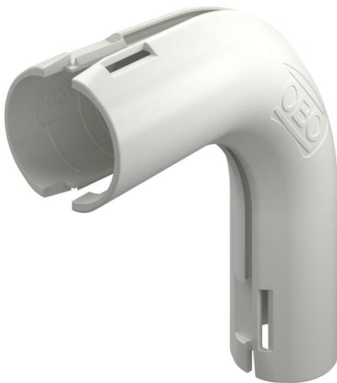
Pieza preformada para tubos de plástico para la instalación eléctrica para crear una curva de 90°. Adecuado para Quick-Pipe® o tubo corrugado. Cierre y apertura sin herramientas. Utilizable en el margen de temperatura de -25 °C a +60 °C.
