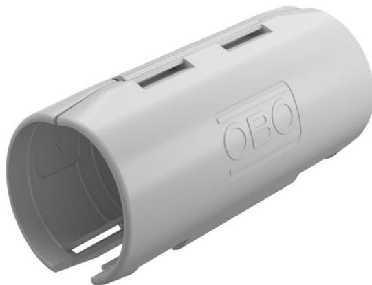
Manguito de unión para tubos de plástico para la instalación eléctrica para crear conexiones longitudinales. Adecuado para Quick-Pipe® o tubo corrugado. Cierre y apertura sin herramientas. Utilizable en el margen de temperatura de -25 °C a +60 °C.
