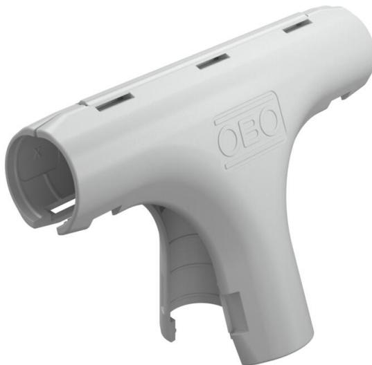
Pieza preformada para tubos de plástico para la instalación eléctrica para crear derivaciones en T. Adecuado para Quick-Pipe® o tubo corrugado. Cierre y apertura sin herramientas. Utilizable en el margen de temperatura de -25 °C a +60 °C.
