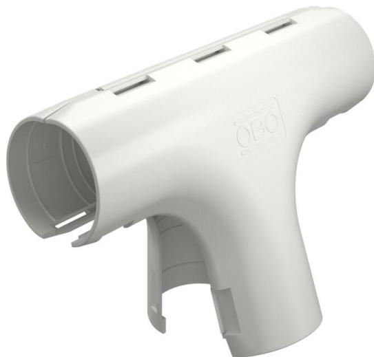
Pieza preformada para tubos de plástico para la instalación eléctrica para crear derivaciones en T. Adecuado para Quick-Pipe® o tubo corrugado. Cierre y apertura sin herramientas. Utilizable en el margen de temperatura de -25 °C a +60 °C.
