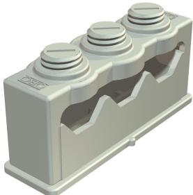
Sujeción sólida de los cables mediante tornillos de apriete, con pata adhesiva, agujero alargado y para enroscar sobre una rosca M6.
