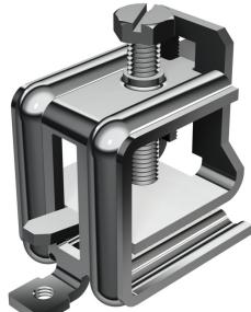
Para la fijación rápida en perfiles de acero durante los montajes de bandejas de cables, abrazaderas sobre perfil, suspensiones de lámparas etc. Un sistema completo está compuesto de 2 abrazaderas para vigas y un trozo de perfil en C de cualquier longitud, así como 2 tapones protectores.
