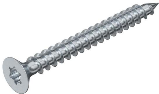
Acero endurecido, electrogalvanizado y con recubrimiento con Hostaflon (PTFE). Cabeza avellanada con ranura en cruz (hexágono interior), tamaños Ø 3 mm T10, Ø 3,5 mm T15, Ø 4 y 4,5 mm T20, Ø 5 mm T25.
