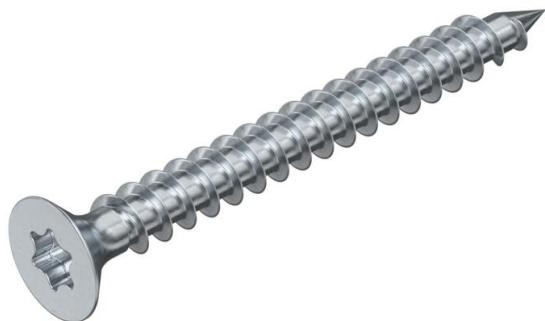
Acero endurecido, electrogalvanizado y con recubrimiento con Hostaflon (PTFE). Cabeza avellanada con ranura en cruz (hexágono interior), tamaños Ø 3 mm T10, Ø 3,5 mm T15, Ø 4 y 4,5 mm T20, Ø 5 mm T25.
