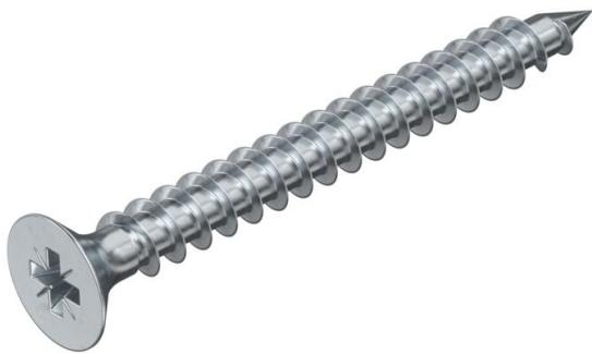
Acero endurecido, electrogalvanizado y con recubrimiento con Hostaflon (PTFE). Cabeza avellanada con ranura en cruz (destornillador tamaño 2, a excepción del Ø de 6 mm que es tamaño 3).
