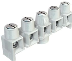
Cuerpo de latón, niquelado, tornillos de acero, electrogalvanizado y pasivado transparente, sección nominal 0,8 ÷ 2,5 mm<sup>2</sup>, tensión nominal 660 V, de 5 polos, con bloques de terminales, sección máx. que se puede conectar en cada cada borne: 4 x 2,5 mm<sup>2</sup>, 5 x 1,5 mm<sup>2</sup> o 6 x 1 mm<sup>2</sup>, los polos no necesarios se pueden separar y ser utilizados como bornes individuales.
