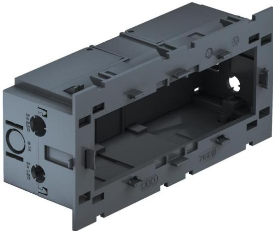
Caja portamecanismos triple de fijación frontal para el sistema Modul 45®. La base se puede quitar o abatir simplificando el proceso de conexión del cableado. Incluye perforaciones para cables de hasta 14 mm.
