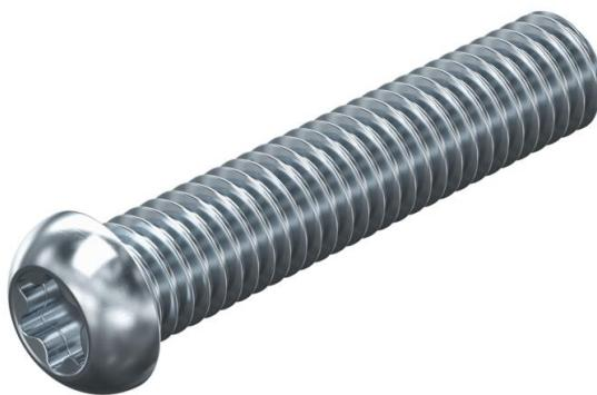
Tornillo de cabeza avellanada con Torx 30, según ISO 7380-1, apropiado para la fijación de trayectos de cable en escuadras y para el montaje de tabiques separadores. Mediante la forma de cabeza redondeada se realiza una protección óptima del cable. El accionamiento Torx ofrece una transmisión óptima de fuerza en el movimiento de tornillo.
