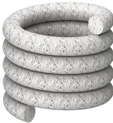
La barrera de insonorización sirve para reducir la transmisión de ruido aéreo, por ejemplo al conducir el sistema de canales a través de pasos de pared entre dos oficinas. La barrera de insonorización está formada por lana de vidrio y se suministra en trenzas con un diámetro de unos 30 mm. El género por metro se suministra en una caja de cartón, la longitud del material es de 50 m. Las trenzas no necesitan estar extremadamente comprimidas al instalarlas.
