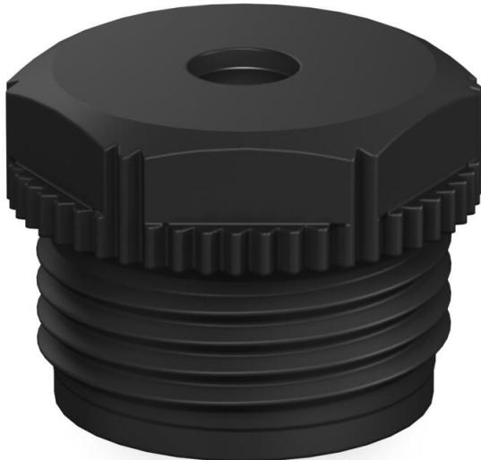
Junta de estrangulación para el roscado en roscas métricas según IEC 423. Con cono autosellante en el extremo de la rosca, por lo que no se requiere anillo de junta de rosca de conexión. Mediante un montaje preciso se puede alcanzar un grado de protección IP54. con entrada de cable abierta.
