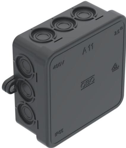
Grado de protección IP55, tensión nominal de 690 V, sección nominal de 2,5 mm<sup>2</sup>, 12 entradas para diámetro de cable de 5-14 mm.
