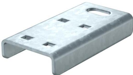
El componente de conexión es la unión de la fijación de varillas roscadas con el sistema de suspensión para los tipos de instalación con bandejas portacables para el mantenimiento de función según DIN 4102, parte 12. Tomillos y tuercas incluidos.
