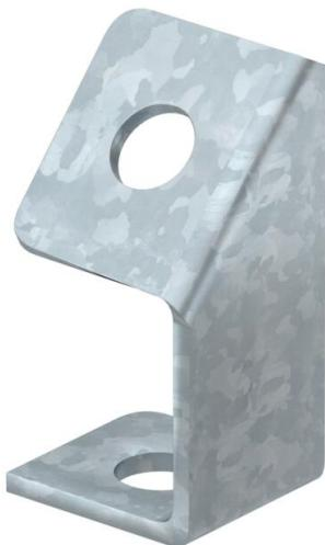
El componente de conexión es el elemento de unión para la disposición oblicua de la fijación de varillas roscadas en un montaje de pared de los tipos de instalación estándar con bandejas de escalera y bandejas portacables para el mantenimiento de función según DIN 4102, parte 12.
