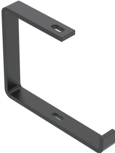
Perfil de suspensión para sistemas de bandejas portacables para fijar directamente bajo el techo o como suspensión con varillas roscadas M10. Revestimiento en negro.
