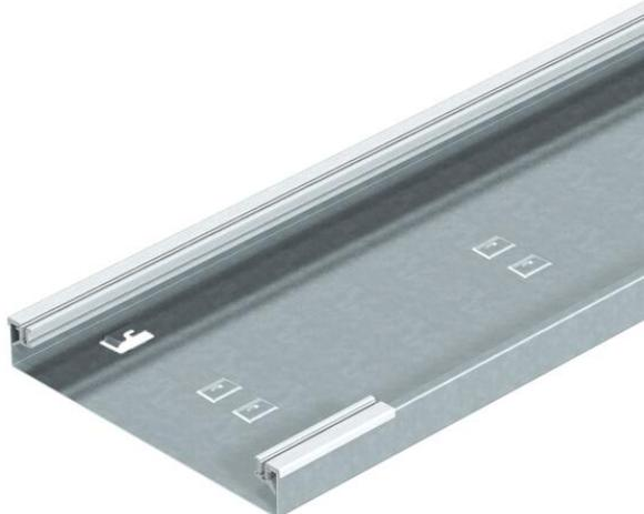
Base de canal de derivación sobre pavimento para tapas ciegas o de montaje biseladas a ambos lados, para el montaje libre sobre el pavimento y con perfiles laterales de aluminio de quita y pon para apoyar y fijar la tapa del canal. La altura del canal es apropiada para montar unidades Telitank.
