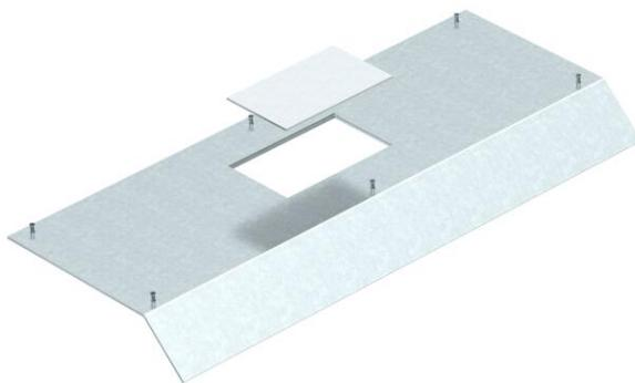
Tapa de conjuntos portamecanismos para la base de canal AIK/U, para el montaje de un conjunto portamecanismos de tamaño 2. La abertura de montaje se cierra con una placa ciega de aluminio de 2 mm. La tapa del canal se atornilla a los perfiles laterales de aluminio de la base del canal. El bisel de la tapa cubre la base del canal formando un ángulo de 45°.
