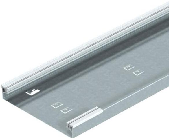
Base de canal sobre pavimento, de un solo conducto, para tapas ciegas o de montaje biseladas por un lado, con perfiles laterales de aluminio para apoyar y fijar la tapa del canal. Dispone de bridas de sujeción para un máximo de 2 paredes separadoras encajables y con conexión conductora y de troquel para una toma de tierra. La altura del canal es apropiada para montar unidades Telitank.
