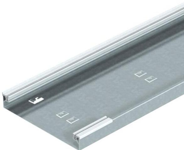
Base de canal sobre pavimento, de 1 compartimento, para tapas ciegas biseladas a un lado, con perfiles laterales de aluminio de quita y pon para apoyar y fijar la tapa del canal, bandeja de suelo con bridas de sujeción para máx. 2 tabiques separadores insertables, auto-contactables y en relieve para ángulo de conexión de conductor protector. Altura de montaje adecuada para la instalación de cajas portamecanismos de tamaño nominal 2.
